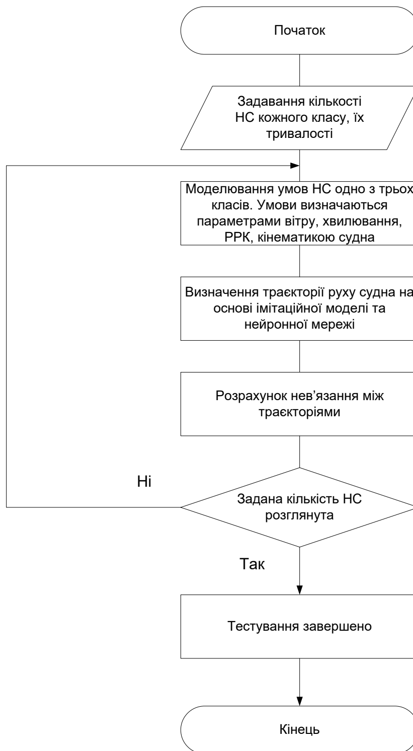
Рисунок 4.3 – Блок-схема алгоритму тестування нейромережевої (нейро- нечітких) системи прогнозування динаміки руху судна при маневруванні у стиснутих водах
