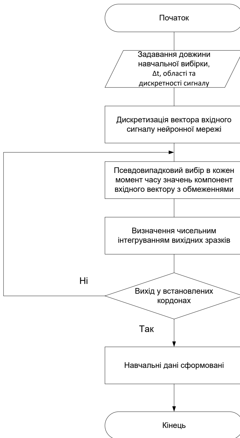
Рисунок 4.2 – Блок-схема алгоритму формування навчальних даних систем, що моделюють кінематику судна (Джерело – розроблено автором)
